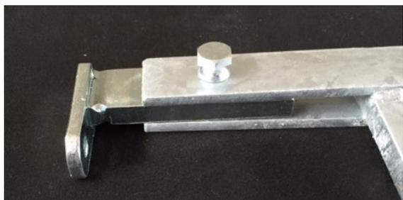
Prepararsi all'installazione inserendo le staffe Easy all'interno degli appositi alloggiamenti, avendo cura di non serrare eccessivamente i rivetti pressometrici Safer, per consentirne l'adattamento alla sede della finestra
